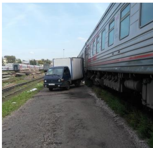
Водитель транспортного средства не включил проблесковый маячок желтого цвета, покинул транспортное средство и не принял мер, исключающих возможность его движения (не изъясл ключи из замка зажигания)
