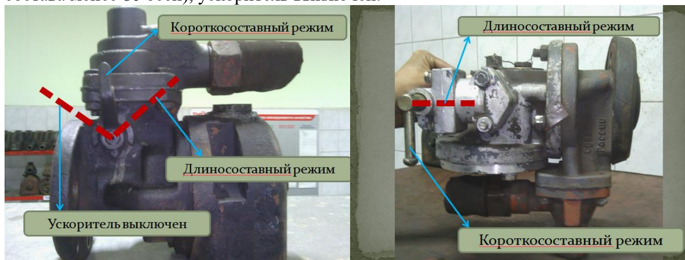
Рисунок 4 Положения ручки переключения режимов ВР усл.№292, усл.№242
